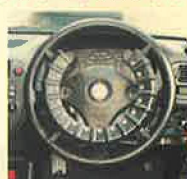
エレクトロニックアクセルリング&ブレーキバー 906EL 手でアクセルとブレーキが操作できる装置。直接ステアリングに取付可能。
